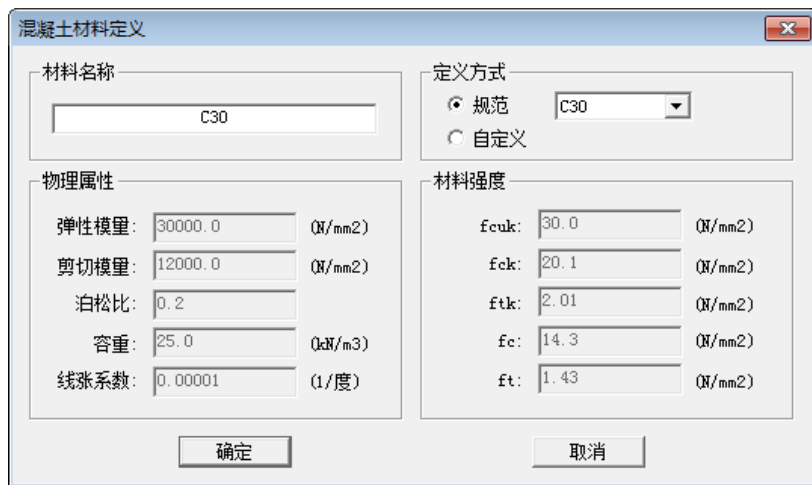
混凝土定义对话框
